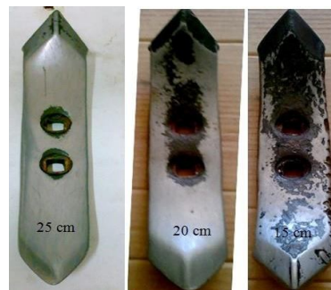
شکل ۲: تیغه‌های قلمی در پایان عملیات در سه عمق مختلف
