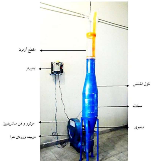
شکل ۴- تونل باد قائم برای اندازه‌گیری سرعت حد
