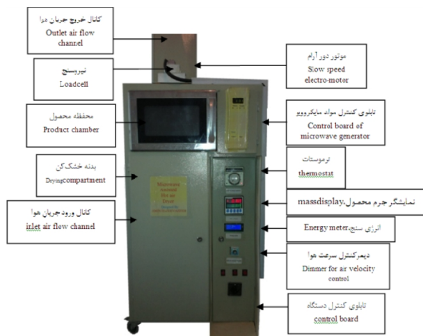
شکل ۱- نمایی از خشک کن ساخته شده Fig1-A view of the manufactured dryer
