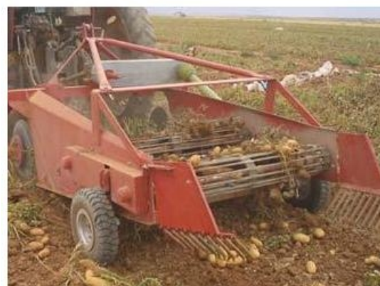
شکل ۱ سیب زمینی کن مورد استفاده در آزمایش Fig. 1 Potato harvester used in the experiment
