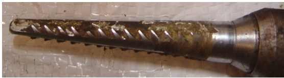
شکل ۲- وضعیت سوزن برداشت پوشیده شده با بقایای برگ Fig. 2. Spindle covered by leaf residue
